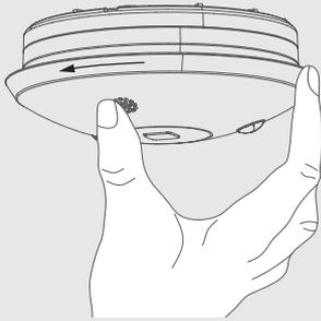
1. Das Gerät gegen den Uhrzeigersinn drehen, um es von der Montageplatte zu lösen (vgl. Abb. links).
