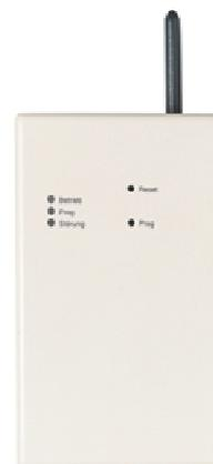
Die zu verstärkenden Sensoren sind sowohl in den Repeater als auch in die Funk-Alarmzentrale einzuprogrammieren. Auf diese Weise ist sichergestellt, dass nur notwendige Signale verstärkt werden.
