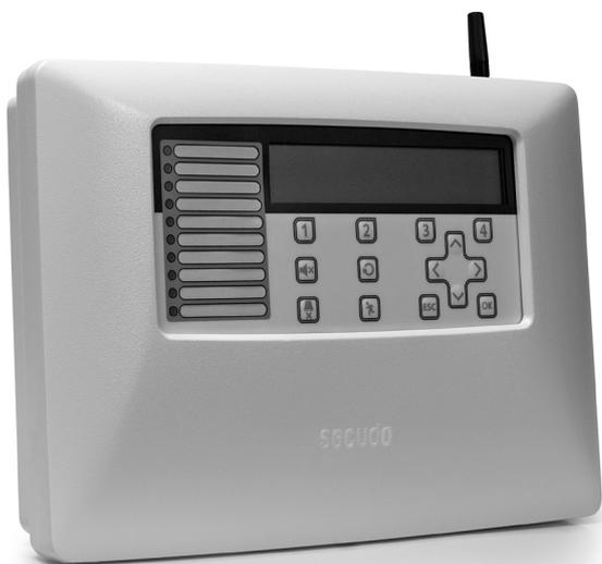
Die Funk-Hybridzentrale N 100 kann alle sicherheitsrelevanten Meldungen des Gebäudes anzeigen und eine Brandfallsteuerung über die Ausgänge vornehmen. Eingangsseitig können in 6 Funk-Gruppen maximal je 10 Funk-Rauchwarnmelder D 110 aufgeschaltet werden sowie an 5 Meldegruppeneingängen verdrahtete Melder angeschlossen werden. Ein 12V / 2.3Ah Akku überbrückt auch längere Netzausfallzeiten.
