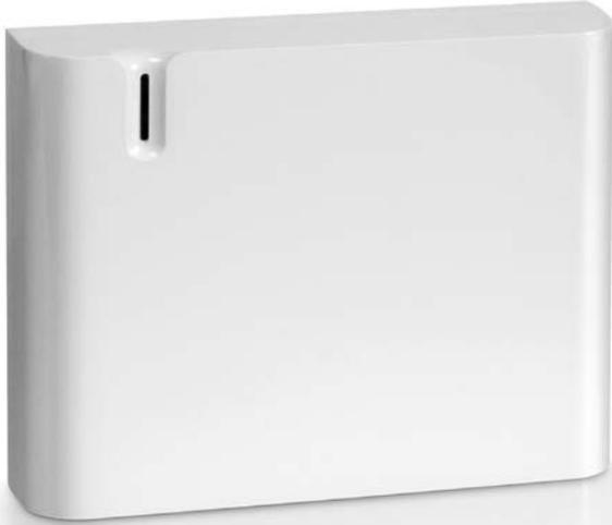
Dieses GSM-Wählgerät V 100 kann ereignisgesteuert Meldungen per SMS und/oder per Sprachausgabe über das 900/1800MHz-GSM Netz versenden. Es stehen 8 Kanäle zur Verfügung. Eine monatliche Routine-Meldung und eine Batterieer-Meldung schaffen zusätzliche Sicherheit. Das Gehäuse kann optional auf Sabotage überwacht werden.
