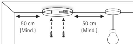
Der Wärmemelder sollte an der Decke und mindestens 50 cm von Wänden und Hindernissen entfernt montiert werden, idealerweise in der Raummitte.
