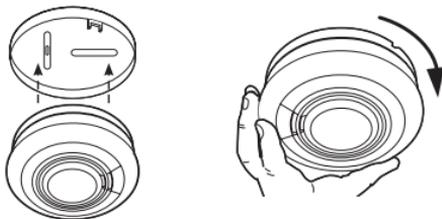
Durch Drehen des Geräts auf den Sockel wird die Batterie automatisch aktiviert.
