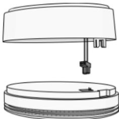
Entfernen Sie den Deckel des Ei Electronics Melders. Der GSM-Melder wird als Deckel verwendet werden. Drücken Sie den verkabelten grünen Stecker in die Pins (bezeichnet mit Text 1 2) des Ei Electronics-Detektors. Stellen Sie sicher, dass der (in der Regel) graue Stecker des Ei Electronics-Detektors entfernt ist.
