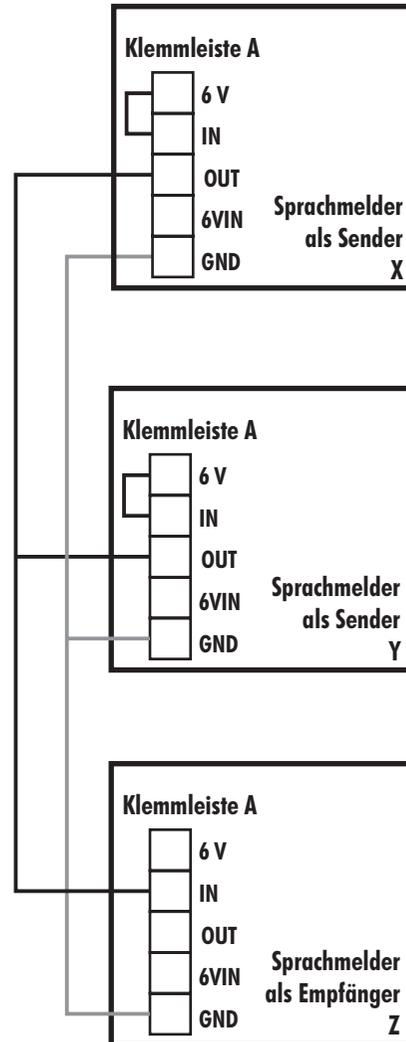
Anschlussbeispiel mit 3 Sprachmeldern bei Betrieb mit Netzgerät
