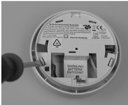
2. Heben Sie vorsichtig die Oberseite der Messkammer ab, indem Sie mit einem kleinen Schraubendreher die je 2 (Position der je 2 Laschen in den Kreisen) kleinen Laschen vorsichtig nach außen biegen (Bild 1) und die kleine Lasche (Bild 2) vorsichtig durch nach innen drücken entriegeln
