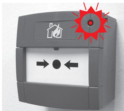
Drücken des Hauscodierungstasters auf der Rückseite, bis die Kontrollleuchte auf der Frontseite rot aufleuchtet. Taster loslassen. Die rote LED blinkt kurz auf, wenn das Gerät in den Hauscodierungsmodus schaltet.
