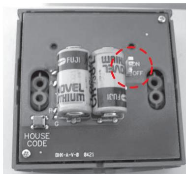
Einschalten des Notwarnknopfs durch Schieben des Schalters auf der Rückseite in „ON“-Stellung.
