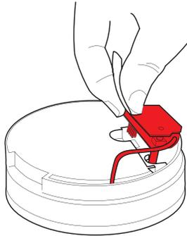
Das Funkmodul in den Warmmelder und die Antenne in die entsprechende Führung einstecken.
