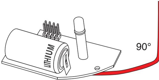
Die Antenne des Funkmoduls an der vorbereiteten Knickstelle um 90° zur Seite der LED abknicken/biegen.
