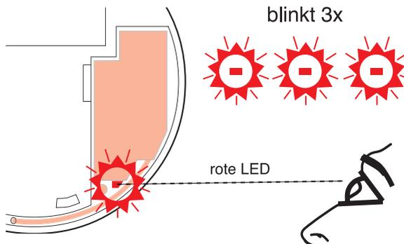
Die rote Kontroll-LED auf der Platine des Funkmoduls blinkt 3x auf, um eine korrekte Verbindung zwischen Warmmelder und Funkmodul zu signalisieren. Vorgang bei allen Warmmeldern wiederholen.
