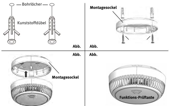
Arretieren Sie den Melder, indem Sie ihn im Uhrzeigersinn auf den Montagesockel drehen, bis er einrastet.
