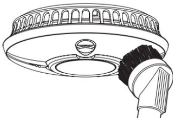
**WARNUNG:** Der FireAngel Rauchmelder kann fälschlicherweise ausgelöst werden, während Sie ihn mit einem Staubsauger reinigen.
