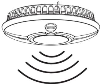
**HINWEIS:** Mit der Testtaste wird die gesamte Elektronik des Rauchmelders überprüft. Es ist nicht erforderlich, Ihren Rauchmelder mit Rauch zu testen. Falls der Rauchmelder beim Testen kein akustisches Warnsignal abgibt, ziehen Sie umgehend den Abschnitt „Fehlerbehebung“ am Ende dieses Handbuchs zu Rate.
