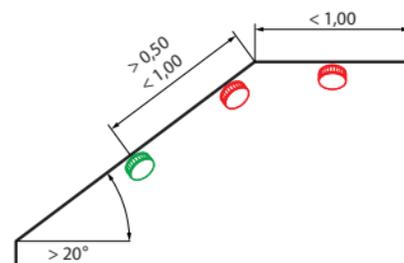
Abb. 8 Gerade Montagefläche weniger als 1 m lang und 1 m breit
