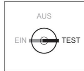
In Stellung ‚TEST‘ reagiert das Ei414 auf ein Testknopf-Signal (aktiviert Feuer- oder CO-Relais, je nachdem, an welchem Gerät der Testknopf gedrückt wurde).
