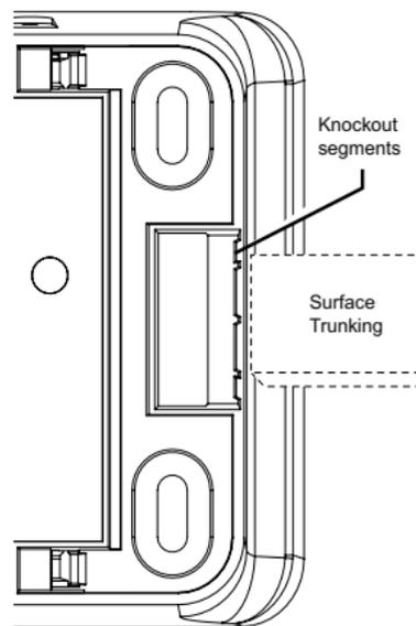
Rückansicht: optionale Verkabelung mit Kabelkanal
