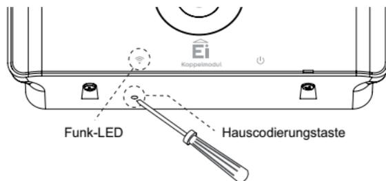
Versehen Sie alle anderen Funkwarnmelder und Funkeinheiten in dem System mit derselben Hauscodierung. Lesen Sie in den Bedienungsanleitungen nach, wie die Warnmelder und Einheiten hauscodiert werden können. Es ist wichtig, dass alle Warnmelder/ Einheiten an ihrer aktuellen Position hauscodiert werden.
