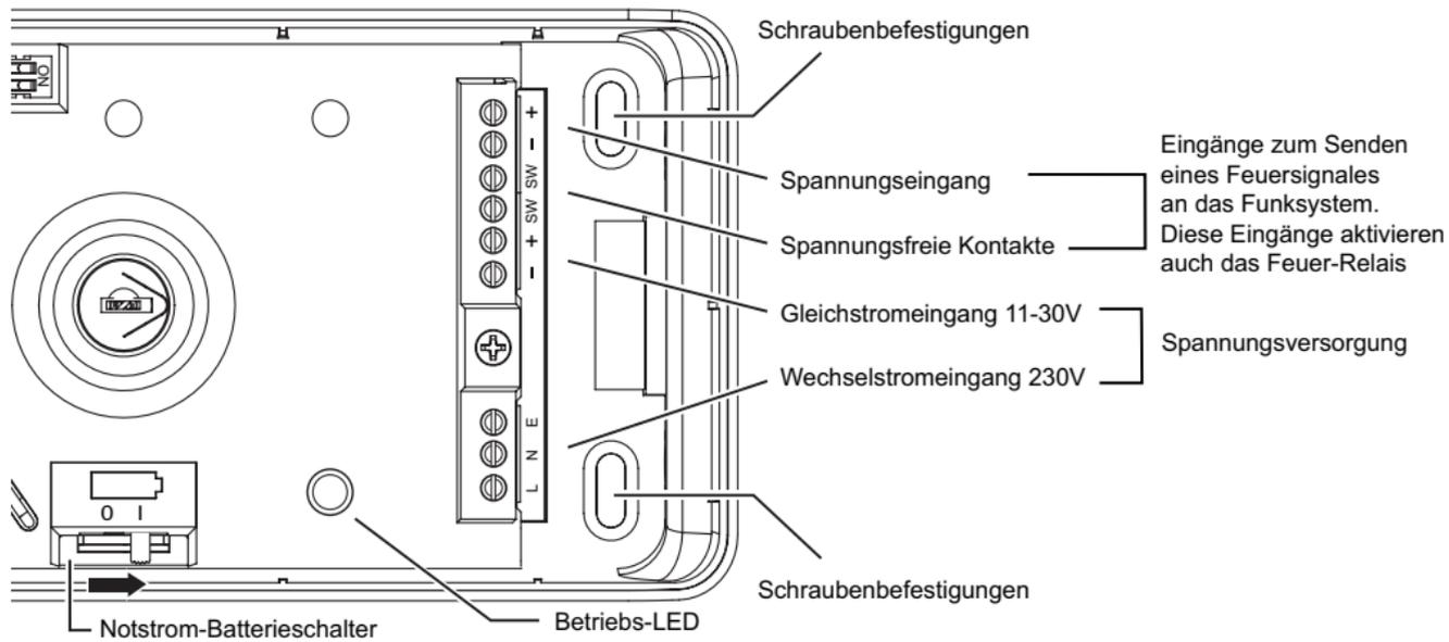
Bitte beachten: Dieser **M U S S** bei der Installation in Stellung ‚EIN‘ geschaltet werden (siehe Abschnitt ‚Montage/Installation‘
