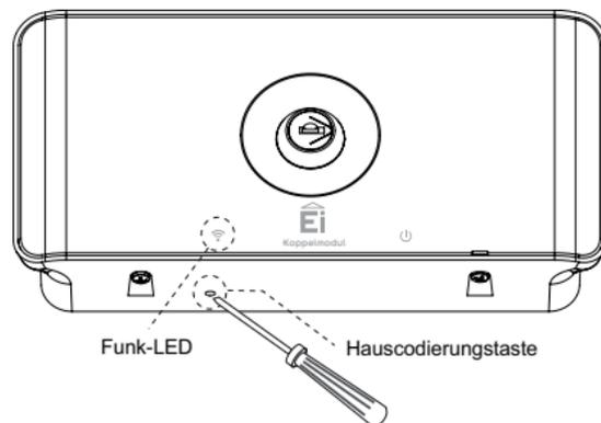
Gehen Sie nun durch das Haus und stellen Sie sicher, dass alle anderen Funkwarnmelder und -Einheiten die richtige Anzahl an Blinksignalen ausgeben.
