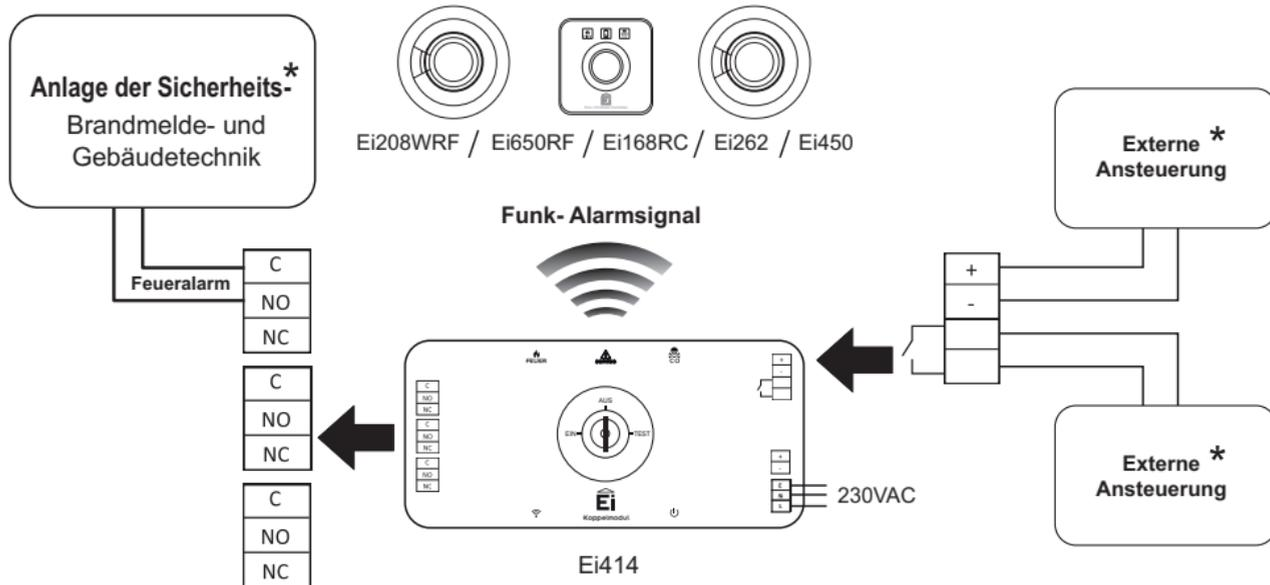
\* Die Klemmenbelegung ist Abhängig von der Anschaltung der Anlagen der Sicherheits-, Brandmelde- oder Gebäudetechnik
